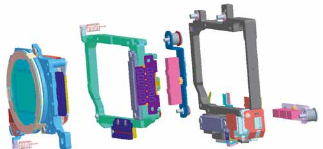
Oben: Komponenten des E-510-Bildstabilisators. Links: In der E-510 sind Ultraschall-Staubschutz (SSWF) und Bildstabilisator (IS) zu einer Einheit zusammengefasst.
